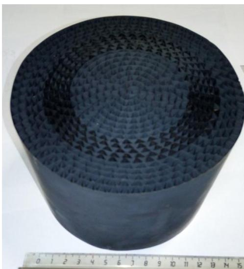
Рисунок 1 - Металлический блок сотовой структуры
